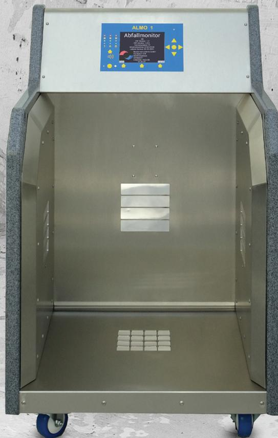
Der Abfallkontrollmonitor dient der einfachen und sicheren Überprüfung von Abfällen auf radioaktive Kontaminationen oder Bestandteile. Er wird z.B. in der Nuklearmedizin auf Radioiodtherapiestationen eingesetzt, da in diesem Bereich ausgeschlossen werden muss, dass bei der täglichen Entsorgung von Abfällen kontaminierte radioaktive Abfälle mit konventionellen Abfällen vertauscht oder vermischt werden. Der Abfallmonitor ermöglicht es, Abfallgebinde messtechnisch zu kontrollieren.
