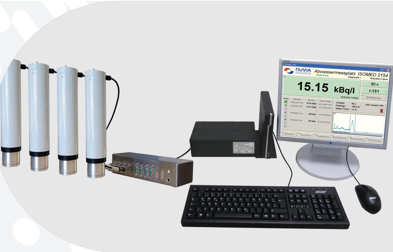
Der Abwassermessplatz ISOMED 2154 dient zur Messung der Aktivität von Radionukliden im Abwasser von nuklearmedizinischen Einrichtungen und Radioiodtherapie-Stationen. Das Abwasser wird in Abklingbehältern gesammelt. Die Aktivität der Radionuklide I-131 oder Tc-99m wird mit Detektoren gemessen, die sich meistens in einem Innenrohr in der Mitte des Abklingbehälters befinden.
