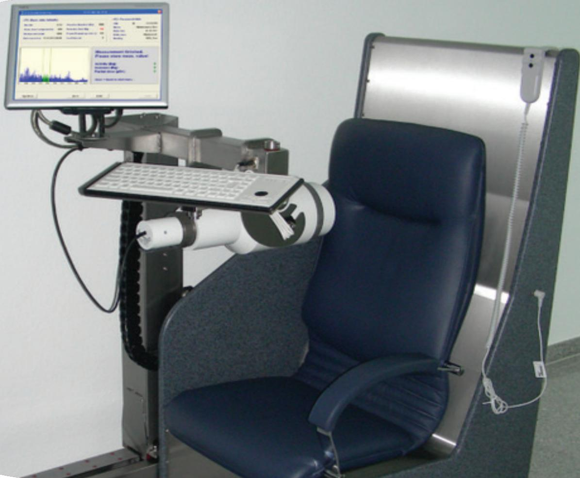
Der Inkorporationsmessplatz ISOMED 2163 dient zur routinemäßigen Inkorporationsmessung an Mitarbeitern von nuklearmedizinischen Einrichtungen, insbesondere von Radioiodtherapie-Stationen.
