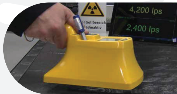
CoMo 170 mit BT-Modul zur kabellosen Datenübertragung
