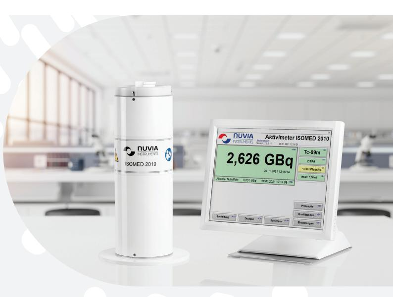
Das Aktivimeter ISOMED 2010 dient der schnellen und genauen Bestimmung der Aktivität und Volumenaktivität von Radiopharmaka, die in der Nuklearmedizin für die Diagnostik und Therapie angewendet werden. Es wird als NetTop-PC in Kombination mit der bewährten NUVIA-Messkammer geliefert.
